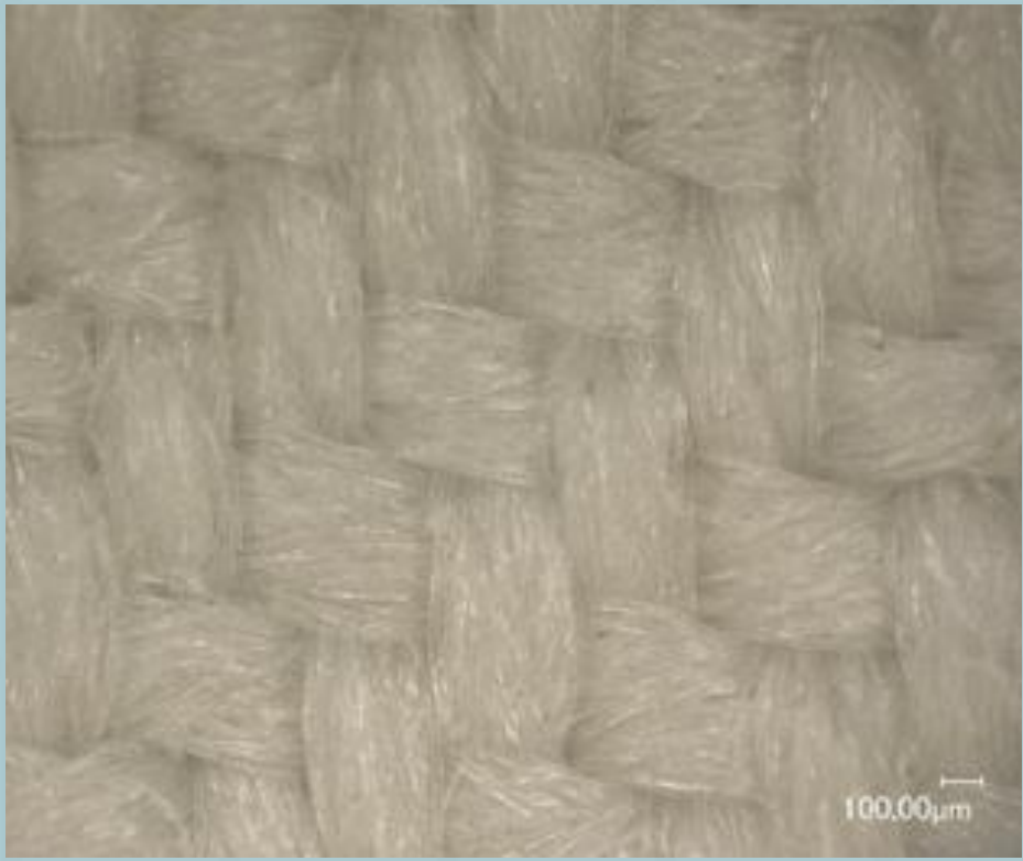
トリグリセリド加工した羊毛サージの接触角と織物表面のマイクロスコープ写真 トリミリスチン、デカン
