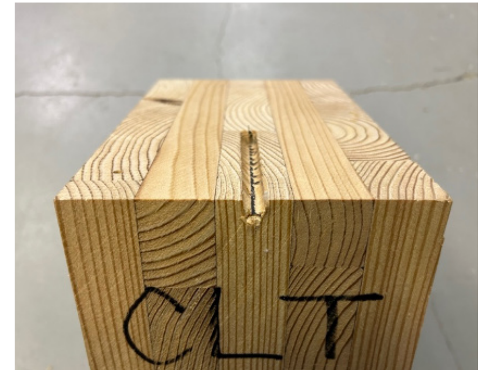
図2 支圧試験体一実験後 (CLT-S1)
