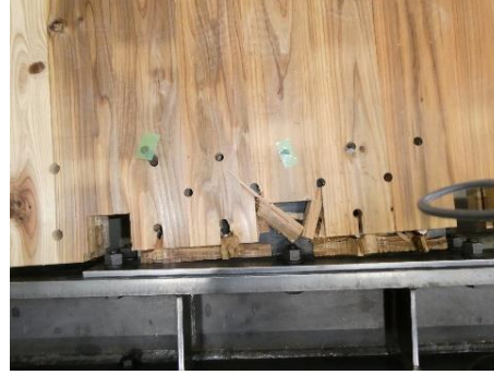
ドリフトピンの損傷
