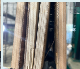
1/150rad載荷時の破壊性状：鋼板座屈、釘の抜けを確認
