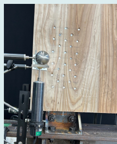
1/150rad載荷時の破壊性状：鋼板座屈、釘の抜けを確認
