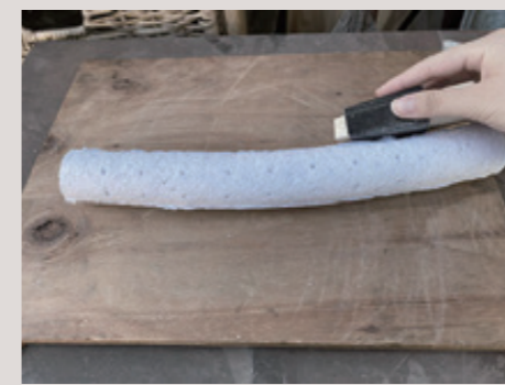
【図10】脚部ヤスリ作業
