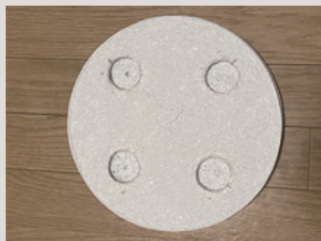
【図12】座面のみ穴あけ手法
