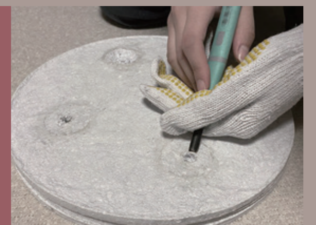
【図29】穴あけ工程
