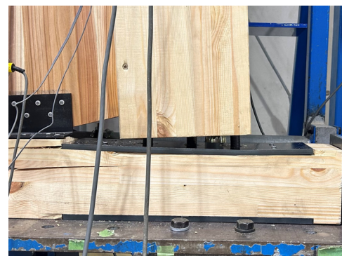
柱脚部の浮き上がり (試験体11)
