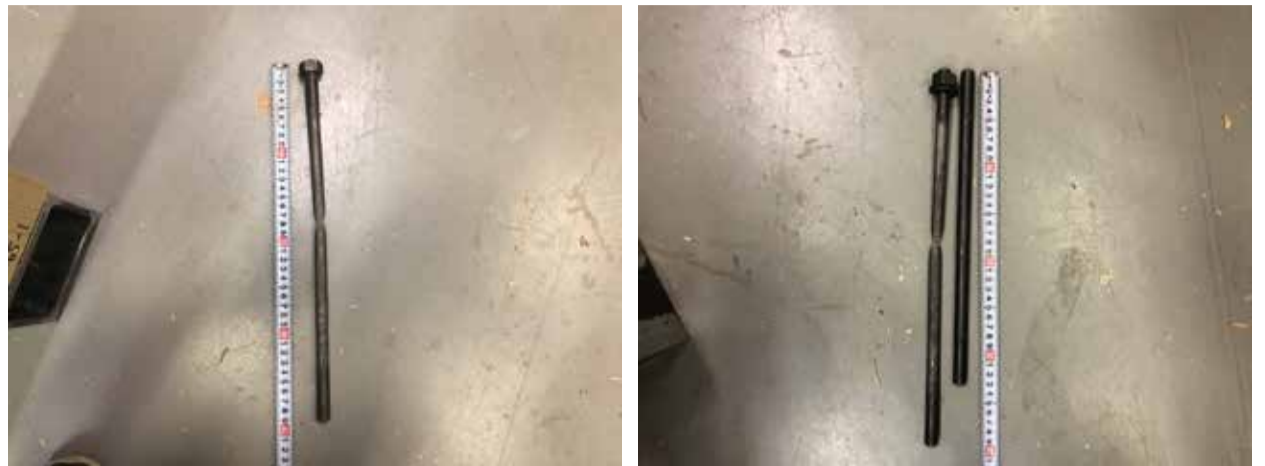
破断したアンカーボルト(左30-65-1)、右Z-30-1
