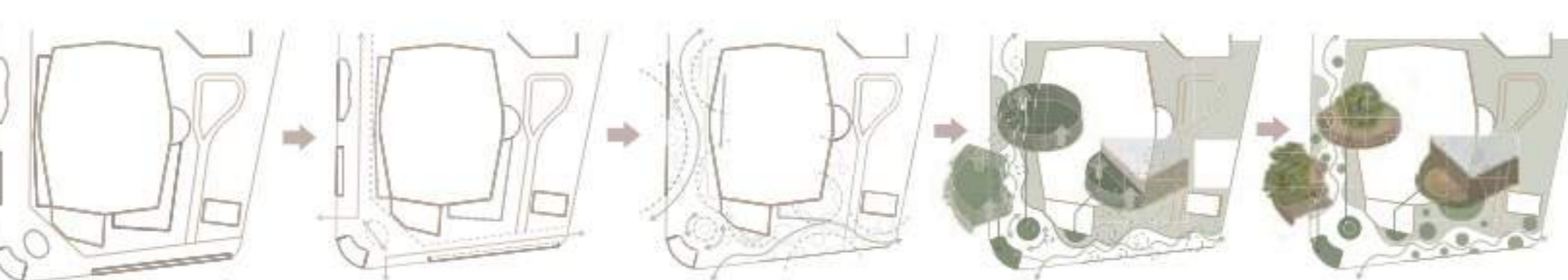
0. 既存 1. 解体・撤去 2. 動線の回遊性を創出 3. ウッドファニチャーの設置 4. 再生完了
