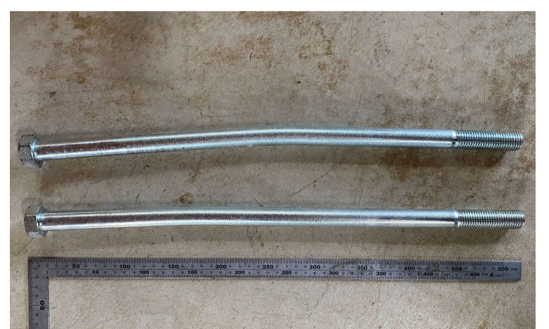
【実験後のボルト 上：引張、下：圧縮】
