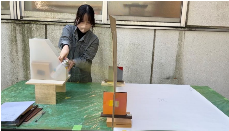
図14. 飛沫実験風景 開口部に向けて噴射する。
