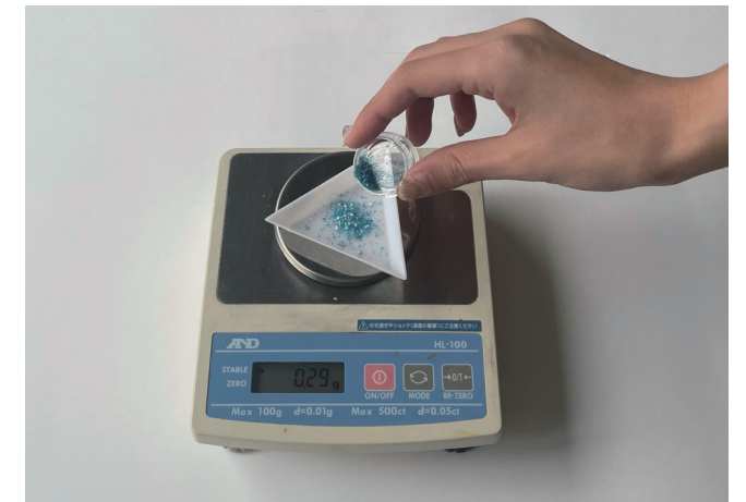
②樹脂に封入する材料を秤で測る
