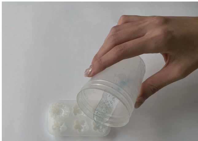
③別のカップに①を 5 g 入れ、②で測った封入物と混ぜ、シリコン型に流し込む
