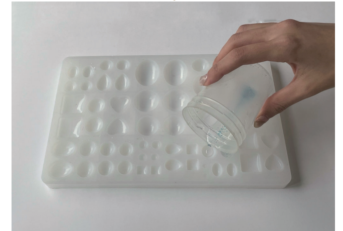
③別のカップに①を 5 g 入れ、②で測った封入物と混ぜ、シリコン型に流し込む
