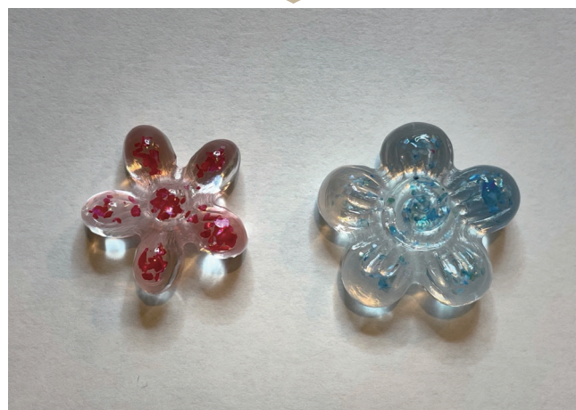
⑤離型した樹脂を研磨し形を整える
