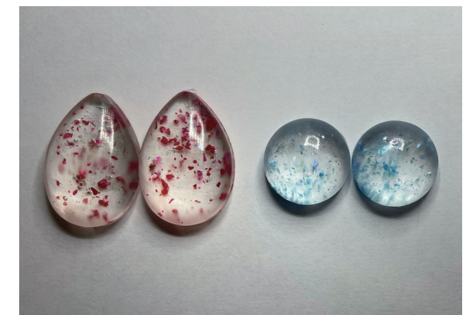
⑤離型した樹脂を研磨し形を整える
