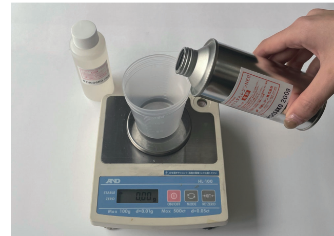
①主剤と硬化剤を 2:1 の割合でカップに入れる。液体が透き通るまで攪拌する
