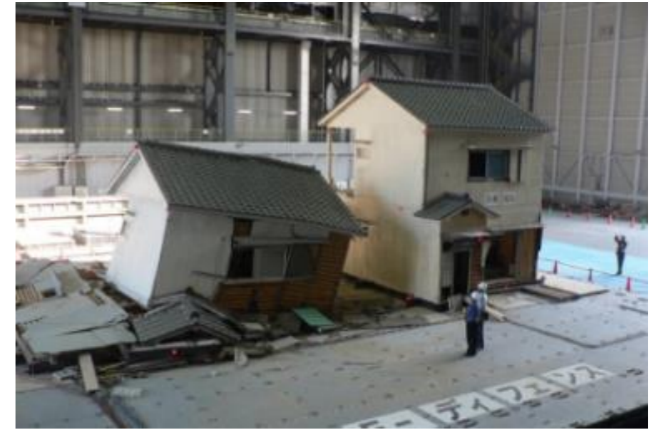
倒壊した既存不適格木造建物(左側)
