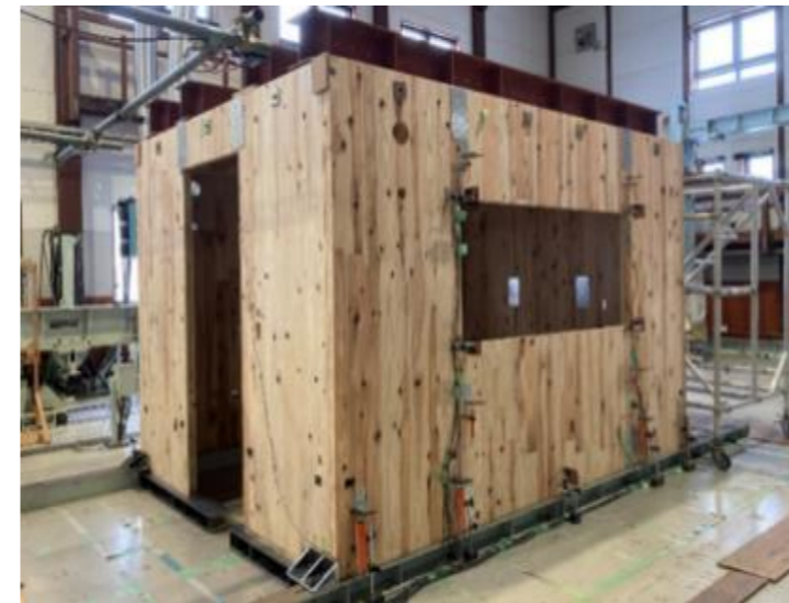
耐震シェルター(振動台実験)
