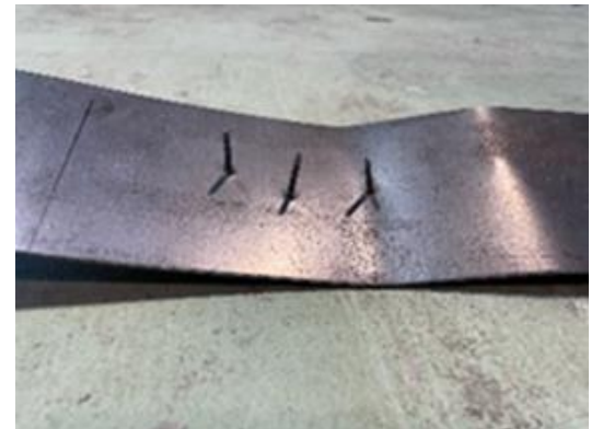
釘貫通の確認
