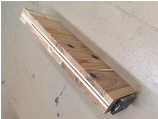
釘打ち施行実験試験体
